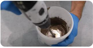
**Step Three**Mix Together (At the specified ratio).
